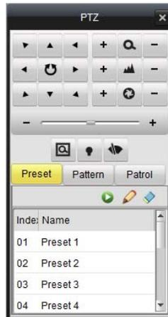
Haga clic en estos botones de dirección para controlar la función PTZ o haga clic en los botones direccionales en el panel de control PTZ. También puede controlar la dirección PTZ mediante los botones de dirección en el teclado.
